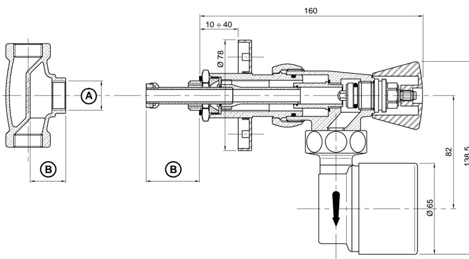
Il contatore – rubinetto è adatto ad essere installato esclusivamente sul corpo sotto intonaco di rubinetti di intercettazione preesistenti con vitone tradizionale e non su rubinetti a sfera o altri modelli (ad eccezione del rubinetto a sfera estraibile TECO mod. 164 – con adattatore dedicato TECO);
